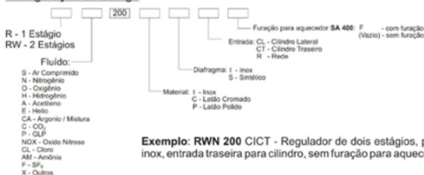
**Exemplo: RWN 200 CICT** - Regulador de dois estágios, para Nitrogênio, em latão cromado, com diafragma em aço inox, entrada traseira para cilindro, sem furação para aquecedor SA 400.
